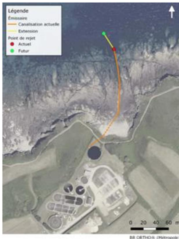
**Situation actuelle** : le rejet des eaux épurées se fait dans la Manche (après stockage dans un bassin à marée), par l'émissaire en mer de 155m de longueur et 400mm de diamètre, 2 heures après la pleine mer et pendant maximum 5 heures le reste du temps.
